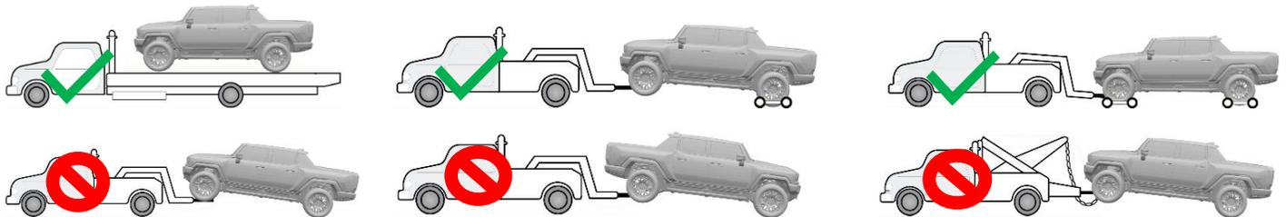
Mover el vehículo con las ruedas motrices en el suelo generará energía no deseada. Limite el movimiento del vehículo a la distancia necesaria para preparar el vehículo para el remolque.
