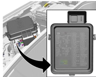
Si es necesario desactivar el claxon antes del transporte, ubique y retire el fusible del claxon del centro eléctrico debajo del cofre.
