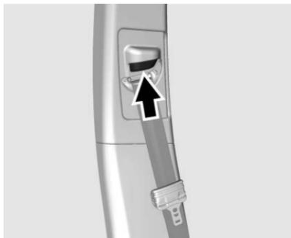
Presione y sostenga el botón de liberación mientras levanta o baja el ajustador de altura a la posición deseada.
