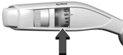
Si está equipado, gire la banda a
