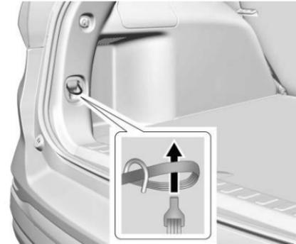
5. Pase el extremo de bucle de la correa a través de uno de los puntos de amarre de carga en la parte trasera del vehículo. Después pase el gancho a través del bucle y jale la correa para apretarla alrededor del amarre de carga.
