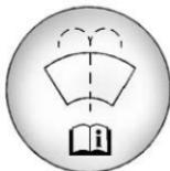
Abra el tapón que tiene el símbolo del lavaparabrisas. Agregue líquido para lavaparabrisas hasta llenar el tanque. Vea en *Vista general del compartimiento del motor* ⇨ 241 la ubicación del depósito.
