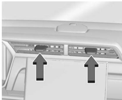
Use las salidas de aire en el centro y parte lateral del tablero de instrumentos para dirigir el flujo de aire. Mueva las perillas centrales sobre las salidas de aire para abrir o cerrar el flujo de aire.
