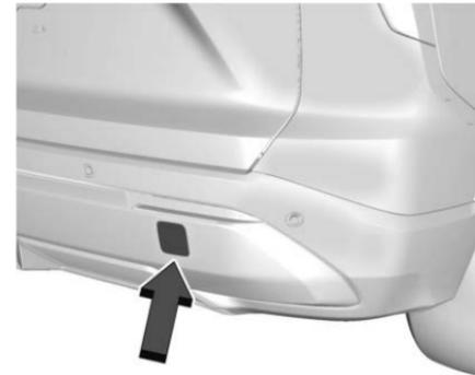
Si está equipado, abra cuidadosamente la cubierta usando la pequeña ranura que oculta el receptáculo trasero de la argolla de remolque.
