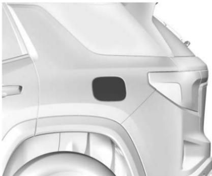
Para abrir la puerta del combustible, presione y suelte el borde central hacia atrás de la puerta. El sistema de relleno de combustible sin tapa no tiene una tapa de combustible.
