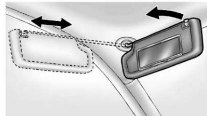
Las viseras del conductor y del pasajero se pueden jalar hacia abajo para bloquear el reflejo del parabrisas. Si está equipado, puede desconectar la visera del montaje central y girarla del parabrisas a la ventana o para extenderla a lo largo de la varilla.
