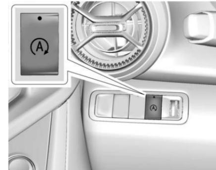
La función automática de paro/arranque del motor se puede desactivar y activar presionando (A). El Paro/arranque se activa cada vez que arranca el vehículo.
