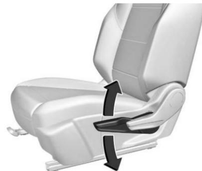
Si está equipado, mueva la palanca hacia arriba o hacia abajo manualmente para subir o bajar el asiento.
