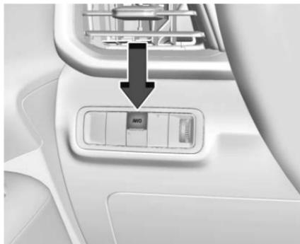
Presione el interruptor para activar el sistema. El indicador parpadea brevemente mientras el sistema se activa y permanece encendido cuando el sistema de Tracción en todas las ruedas está activo. Consulte *Luz All Wheel Drive (Tracción en las cuatro ruedas)* ⇨ 100.
