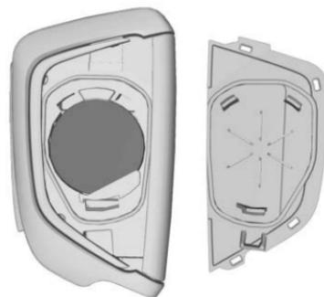
3. Retire la batería vieja. No utilice un objeto metálico.
