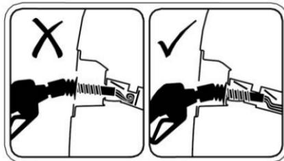
El sistema sin tapa tiene dos puertas de aleta internas. Para evitar el rocío de combustible, inserte la boquilla completamente para asegurar que ambas puertas estén abiertas antes de cargar combustible.
