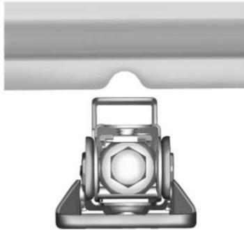
9. Coloque la cabeza de elevación del gato en el punto para colocación del gato que esté más cerca de la llanta pinchada. Ese punto está indicado por una ranura en el borde inferior vertical del lado de la lámina de carrocería.
