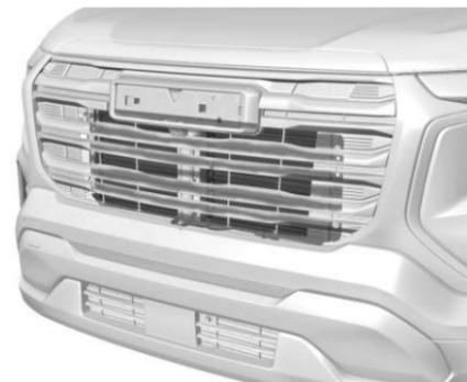
Este vehículo puede tener un sistema de obturador que cierra automáticamente la abertura de enfriamiento frontal. Este sistema está diseñado para ayudar a mejorar la economía del combustible. Asegúrese que el sistema de obturador esté libre de cualquier desechos, nieve o hielo.
