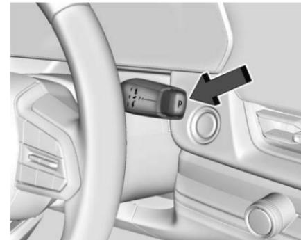
El patrón de cambios se muestra en la parte delantera de la palanca de cambios. La posición de velocidad seleccionada se iluminará en rojo en la palanca de cambios, mientras que todas las demás se proyectarán en blanco. Si el cambio no es inmediato, como en condiciones
