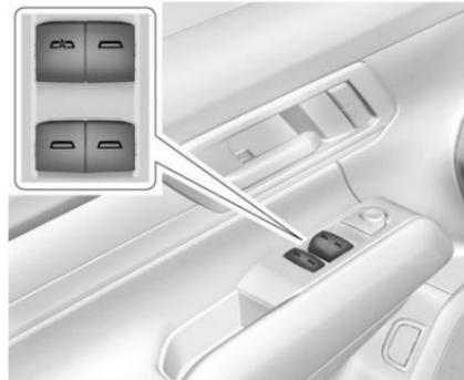
Las ventanas eléctricas funcionan cuando el vehículo está encendido, en modo de accesorios, o cuando la Energía retenida para los accesorios está activa. Consulte *Energía retenida para los accesorios (RAP)* ⇨ 181.
