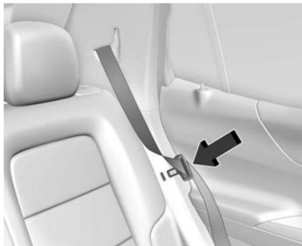
1. Guarde el cinturón de seguridad en el sujetador de almacenamiento del cinturón.
