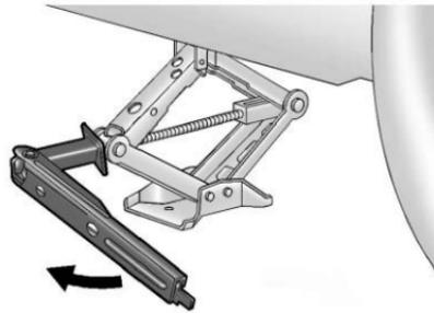
10. Levante el vehículo, haciendo girar la manija del gato en el sentido de las manecillas del reloj. Eleve el vehículo a una altura tal, de manera que haya espacio suficiente para que la llanta usada no toque el suelo.
