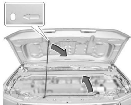
3. Levante el cofre sólo suficiente para liberar la varilla de soporte del cofre de su retenedor e insértelo en la ranura marcada con una flecha en el lado inferior del cofre. Elevar el cofre demasiado lejos puede desconectar las partes adyacentes a las bisagras.
