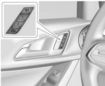
Si está equipado, la función de asiento con memoria permite que los conductores guarden sus posiciones de conducción únicas y una posición para salir compartida.
