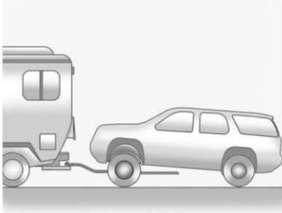
Para remolcar el vehículo desde el frente con las ruedas traseras en contacto con el suelo:
