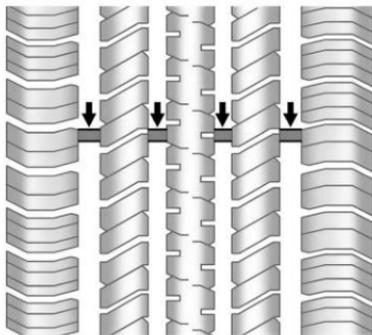
Los indicadores de desgaste del dibujo son una de las maneras de decidir cuándo es el momento para nuevas llantas. Los indicadores de desgaste aparecen cuando las llantas tienen solamente 1.6 mm (1/16 de pulgada) de dibujo remanente. Vea *Inspección de llantas* ⇨ 282 y *Rotación de la llanta* ⇨ 282.
