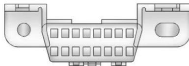
El DLC está debajo del tablero de instrumentos del lado izquierdo del volante. Conectar dispositivos que no se utilicen para realizar una Inspección de emisiones/Prueba de mantenimiento o para dar servicio al vehículo puede afectar la operación del vehículo. Vea *Equipo eléctrico incorporado* ⇨ 235. Visite a su distribuidor si necesita asistencia.
