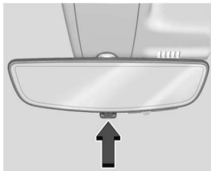
Jale la pestaña para activar la pantalla. Empuje la pestaña para apagarla. Cuando está apagado el espejo tiene atenuación automática. Ajuste el espejo para una visión clara del área situada detrás del vehículo mientras la pantalla está apagada.
