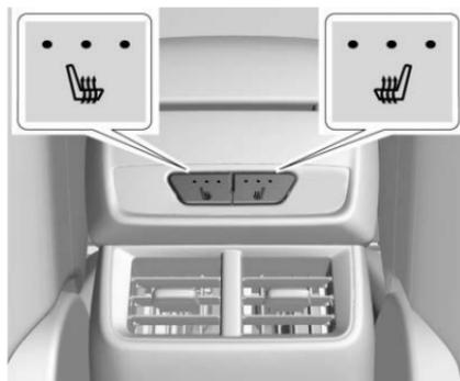
Si está equipado, los botones del asiento trasero con calefacción se encuentran detrás de la consola central. Para que funcione, el motor debe estar encendido.
