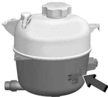
Revise si se alcanza a ver refrigerante en el tanque de compensación del refrigerante. Si el refrigerante que está dentro del tanque de compensación del refrigerante está hirviendo, no haga nada más hasta que se enfríe. Si el refrigerante está visible pero la marca de nivel de refrigerante no lo está, agregue una mezcla 50/50 de agua limpia
