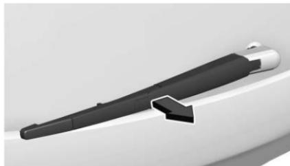
1. Levante el brazo del limpiador para separarlo del parabrisas.
