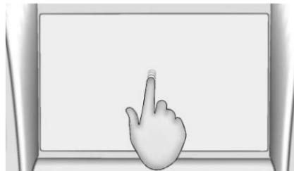
Nudge (vibración) se usa para mover los elementos una distancia corta en una lista o un mapa. Para nudge (vibración), sostenga y mueva el elemento seleccionado hacia arriba o abajo a una nueva ubicación.
