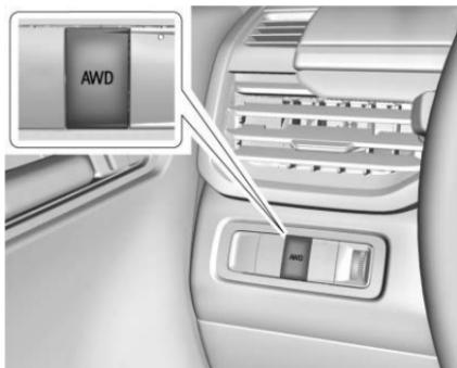
Presione el interruptor para activar el sistema de Tracción en todas las ruedas. El indicador parpadea brevemente mientras el sistema se activa y permanece encendido cuando el sistema está activo. Consulte *Luz All Wheel Drive (Tracción en las cuatro ruedas)* ▷ 116.
