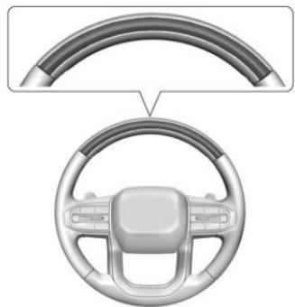
La barra de luz del volante y la luz del grupo de instrumentos proporcionan la siguiente información importante sobre la operación de Super Cruise:
