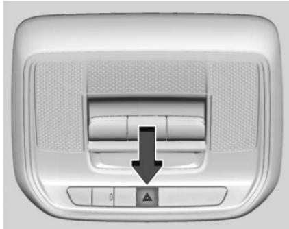
**⚠ :** Presione este botón en la consola superior para encender y apagar intermitentemente las luces direccionales delanteras y traseras. Esto advierte a otros que usted está teniendo problemas. Presione nuevamente para apagar las intermitentes.
