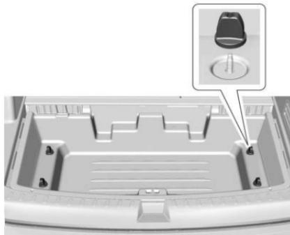
3. Retire las cuatro tuercas de mariposa y después retire el sistema de administración de carga. Vea *Sistema de administración de la carga* ▷ 91.
