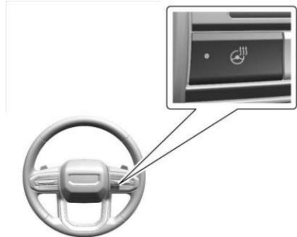
➊ : Si esta equipado, presione para prender o apagar el volante de dirección con calefacción. Aparece una luz junto al botón cuando la función está encendida.
