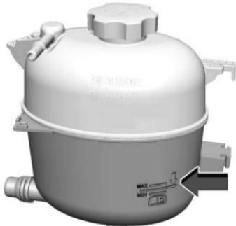
3. Llene el tanque de compensación del refrigerante con la mezcla adecuada hasta la marca de nivel indicado.
