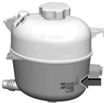
Revise si se alcanza a ver refrigerante en el tanque de compensación del refrigerante. Si el refrigerante que está dentro del tanque de compensación del refrigerante está hirviendo, no haga nada más hasta que se enfríe. Si el refrigerante está visible pero la marca de nivel de refrigerante no lo está, agregue una mezcla 50/50 de agua limpia y potable con refrigerante DEX-COOL en el
