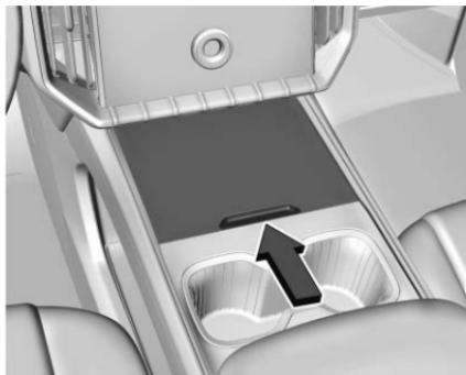
Si está equipado, empuje la cubierta para abrir el compartimento de almacenamiento delantero.
