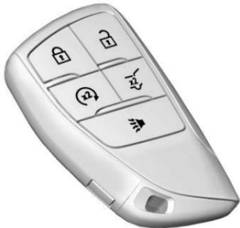
**🔒** : Oprima para cerrar los seguros de todas las puertas. Las luces direccionales pueden parpadear y/o el claxon puede sonar en la primera presión para indicar el bloqueo. Para ver las configuraciones disponibles para esta función desde la pantalla de infoentretenimiento, toque Configuración > Vehículo > Bloqueo, desbloqueo, arranque remotos.
