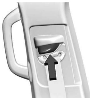
Presione y sostenga el botón de liberación mientras levanta o baja el ajustador de altura a la posición deseada.
