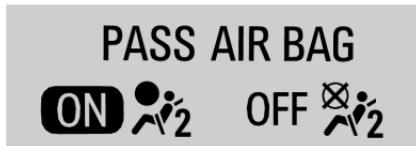
Los símbolos del indicador de estado de la bolsa de aire del pasajero se iluminarán por varios segundos como una verificación del sistema. Entonces, después de varios segundos más, el indicador de estado se iluminará para indicarle el estado de la bolsa de aire delantera del pasajero externo delantero. Vea *Indicador de estado de bolsa de aire del pasajero* ▷ 111.
