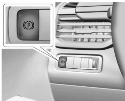
El Freno de estacionamiento eléctrico siempre puede aplicarse, incluso con el vehículo apagado. En caso de energía
