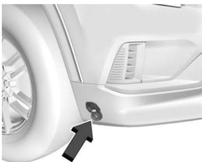
Si está equipado, el calentador del motor puede proporcionar un arranque más fácil y mayor economía de combustible durante el calentamiento del motor en condiciones de clima frío o menor a  $-18^{\circ}\text{C}$  ( $0^{\circ}\text{F}$ ). Los vehículos
