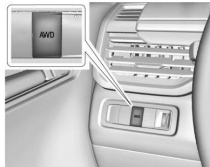
**Modo de Tracción en todas las ruedas:** El modo de Tracción en todas las ruedas proporciona torque de conducción a las cuatro ruedas. Seleccione Tracción en las cuatro ruedas para mejorar la tracción y control en superficies resbaladizas del camino, como grava, arena, pavimento mojado, nieve y hielo.
