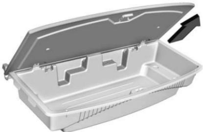
1. Retire el piso de carga. Abra el piso de carga aproximadamente 70% y jale hacia arriba y afuera para liberar los dos ganchos de la varilla fija al sistema de administración de carga.
