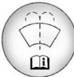
Abra el tapón que tiene el símbolo del lavaparabrisas. Agregue líquido para lavaparabrisas hasta llenar el tanque. Vea en *Vista general del compartimiento del motor* ▷ 290 la ubicación del depósito.
