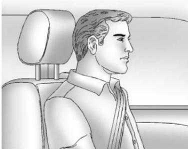
Ajuste las cabeceras de tal forma que la parte superior de la misma esté a la misma altura que la parte superior de la cabeza del ocupante. Esta posición reduce la probabilidad de una lesión de cuello durante un accidente.
