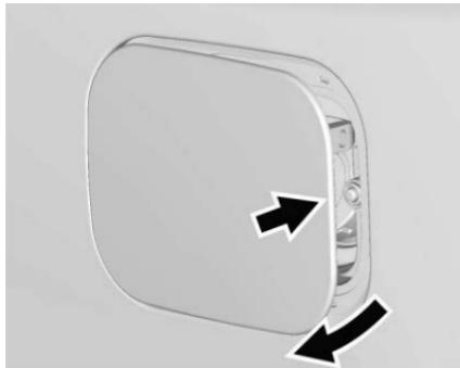
Para abrir la puerta del combustible, presione y suelte el borde central hacia atrás de la puerta. El sistema de llenado de combustible sin tapa no tiene una tapa de combustible.
