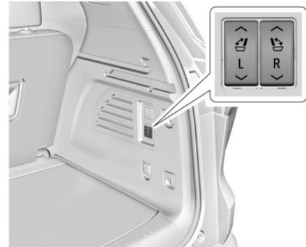
Si está equipado, los respaldos de la tercera fila también se pueden pliegarse hacia adelante y volver a la posición vertical presionando sin soltar los interruptores en el lado del pasajero del área de carga trasera.
