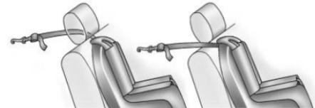
Si la posición que utiliza tiene una cabecera fija y está utilizando una sola atadura, tienda la atadura debajo de la cabecera y entre los postes de la cabecera o alrededor del lado exterior de la cabecera.
