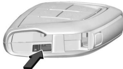
2. Separe las dos mitades de la llave remota utilizando la hoja de la llave mecánica insertada en el centro inferior de la llave remota. No use la ranura de la llave.
