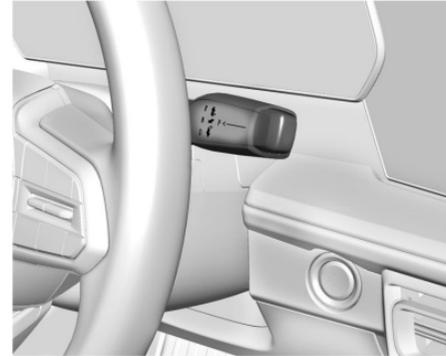
El patrón de cambios se muestra en la parte delantera de la palanca de cambios. La posición de velocidad seleccionada se iluminará en rojo en la palanca de cambios, mientras que todas las demás se proyectarán en blanco. Si el cambio no es inmediato, como en condiciones muy frías, el indicador en el interruptor de cambios puede parpadear hasta que esté completamente conectado.
