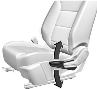
Si está equipado, mueva la palanca hacia arriba o hacia abajo manualmente para subir o bajar el asiento.
