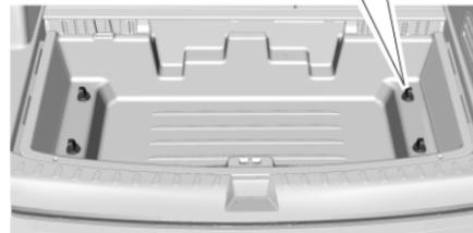
3. Retire las cuatro tuercas de mariposa y después retire el sistema de administración de carga. Vea *Sistema de administración de la carga* ⇨ 88.
