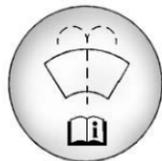
Abra el tapón que tiene el símbolo del lavaparabrisas. Agregue líquido para lavaparabrisas hasta llenar el tanque. Vea en *Vista general del compartimiento del motor* ⇨ 299 la ubicación del depósito.
