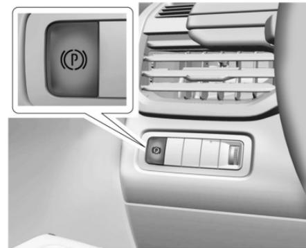
El Freno de estacionamiento eléctrico (EPB) siempre puede aplicarse, incluso con el vehículo apagado. En caso de falta de energía
