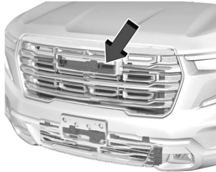
El vehículo puede contar con un sistema de obturador diseñado para ayudar a mejorar la economía de combustible. Mantenga el sistema de obturador libre de desechos, nieve y hielo. Si la luz revisar el motor está activada, verifique si el sistema de obturador está libre de desechos, nieve o hielo.
