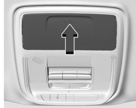
El almacenamiento de lentes para el sol está en la consola superior. Presione la cubierta y libere para tener acceso.
