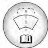
Abra el tapón que tiene el símbolo del lavaparabrisas. Agregue líquido para lavaparabrisas hasta llenar el tanque. Vea en *Vista general del compartimento del motor* ⇨ 295 la ubicación del depósito.
