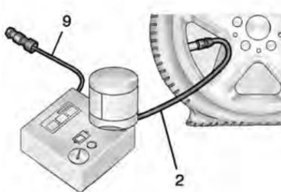
7. Coloque la manguera de aire/sellador (2) al vástago de la válvula de la llanta, haciéndola girar en sentido de las manecillas del reloj hasta que esté apretada.
