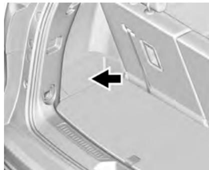
El bloque de fusibles del compartimiento trasero se encuentra detrás del tablero de moldura en el lado del conductor del compartimento de almacenamiento trasero.
