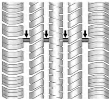
Los indicadores de desgaste del dibujo son una de las maneras de decidir cuándo es el momento para nuevas llantas. Los indicadores de desgaste aparecen cuando las llantas tienen solamente 1.6 mm (1/16 de pulgada) de dibujo remanente. Vea *Inspección de llantas* ⇨ 341 y *Rotación de la llanta* ⇨ 341.
