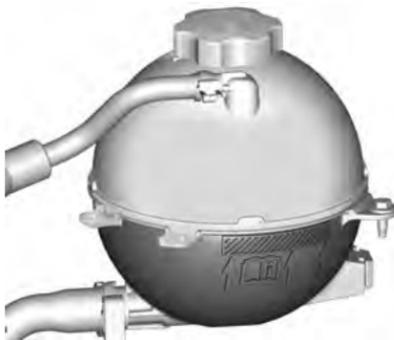
Revise si se alcanza a ver refrigerante en el tanque de compensación del refrigerante. Si el refrigerante que está dentro del tanque de compensación del refrigerante está hirviendo, no haga nada más hasta que se enfríe. Vea *Sobrecalentamiento del motor* ⇨ 307.
