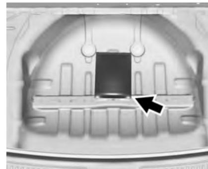
1. Retire el paquete de cables de debajo de la llanta de refacción, el gato y las herramientas, o del contenedor del gato.
