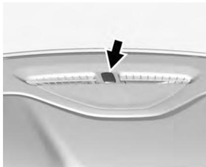
El sensor solar, ubicado en la rejilla del desempañador a la mitad del tablero de instrumentos, monitorea el calor solar. No cubra el sensor solar, de lo contrario, el sistema no funcionará adecuadamente.
