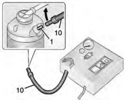
4. Conecte la manguera de sólo aire (10) a la válvula de entrada del recipiente de sellado (1) en el sentido de las manecillas del reloj hasta que quede apretada.
