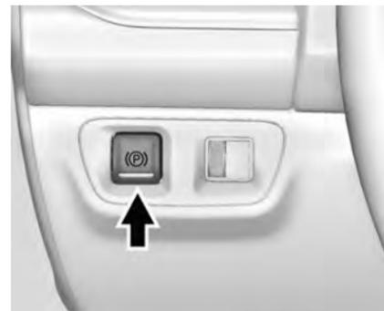
El Freno de estacionamiento eléctrico (EPB) siempre puede aplicarse, incluso con el vehículo apagado. En caso de falta de
