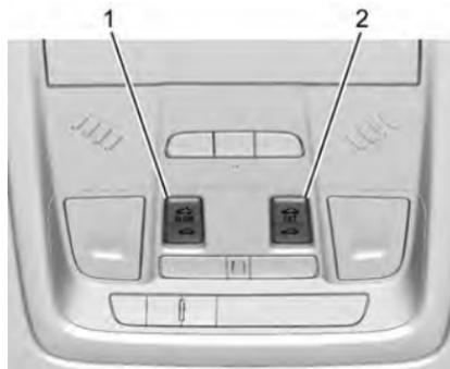
1. Interruptor de quemacocos (SLIDE - Deslizar)
