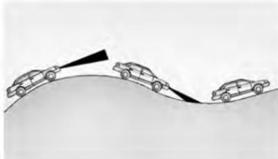
No utilice el ACC al conducir en colinas pronunciadas o al arrastrar un remolque, el ACC no detectará un vehículo en el carril al conducir en colinas pronunciadas. El conductor necesitará a menudo hacerse cargo de la aceleración y el frenado en colinas pronunciadas, especialmente al arrastrar un remolque. Si aplica los frenos, el ACC se desactiva.
