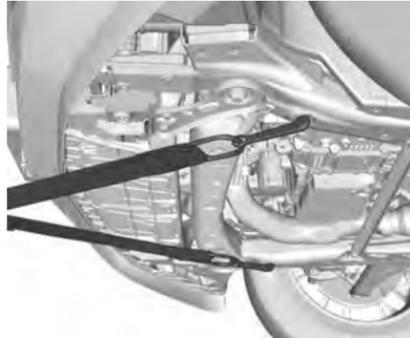
El vehículo está equipado con puntos de conexión específicos que serán usados por el proveedor de remolque. Estos orificios se puede usar para jalar el vehículo desde una superficie de camino plano sobre el camión de remolque de plataforma plana.
