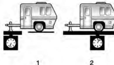
El peso de la lengüeta de remolque (1) debe ser 10–15 % del peso del remolque cargado (2). Algunos tipos de remolques específicos,
