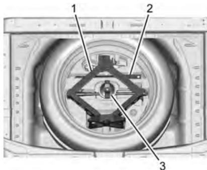
4. Gire la tuerca de mariposa (3) en sentido contrario al de las manecillas del reloj para remover el gato (1) y la llave de ruedas (2). Coloque el contenedor de herramientas cerca de la llanta que se va a cambiar.
