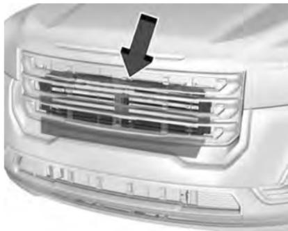
El vehículo puede contar con un sistema de obturador diseñado para ayudar a mejorar la economía de combustible. Mantenga el sistema de obturador libre de desechos, nieve y hielo. Si la luz revisar el motor está activada, verifique si el sistema de obturador está libre de desechos, nieve o hielo.
