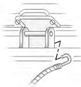
5. Conecte el cable en la parte externa de las bisagras de la puerta trasera.
