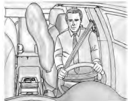
La bolsa de aire central delantera está en el lado interno del respaldo del conductor.
