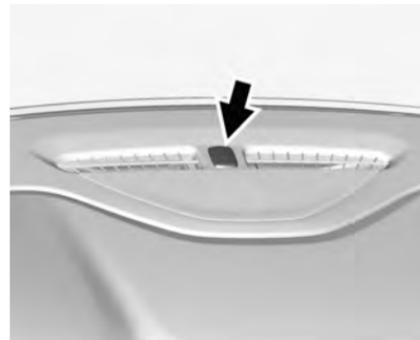
Hay un sensor de luz en la parte superior del tablero de instrumentos. No cubra el sensor.
