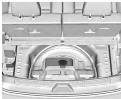
4. Gire la tuerca del retenedor en sentido contrario a las manecillas del reloj para retirar la bolsa del juego de sellador de llanta y compresor.
