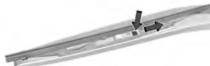
2. Empuje la palanca de liberación para desconectar el gancho y empuje el brazo del limpiador hacia el centro del vehículo y fuera del ensamble de la hoja.
