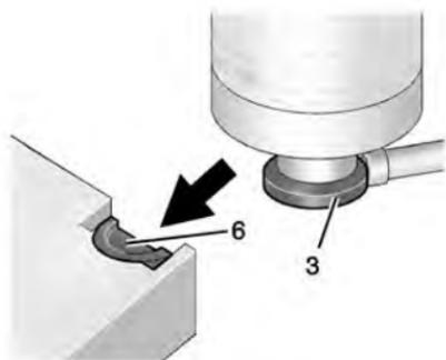
5. Deslice la base del recipiente de sellador de llantas (3) en la ranura en la parte superior del compresor (6) para sostenerlo hacia arriba.
