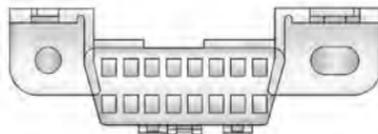
El DLC está debajo del tablero de instrumentos del lado izquierdo del volante. Conectar dispositivos que no se utilicen para
