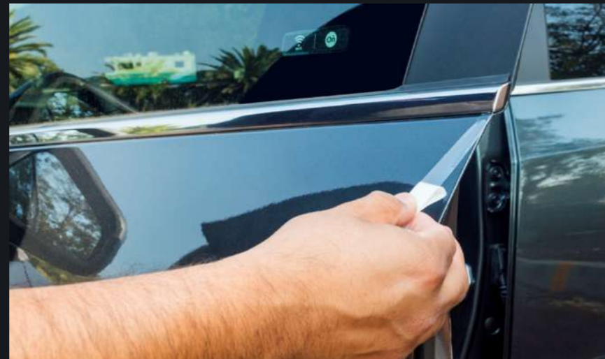
CINTA DE PROTECCIÓN DE PINTURA PARA FILOS DE PUERTA
