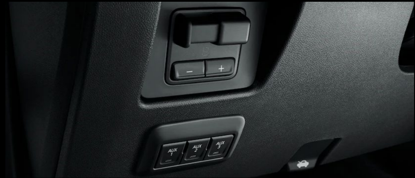
Interruptor de kits de iluminación
